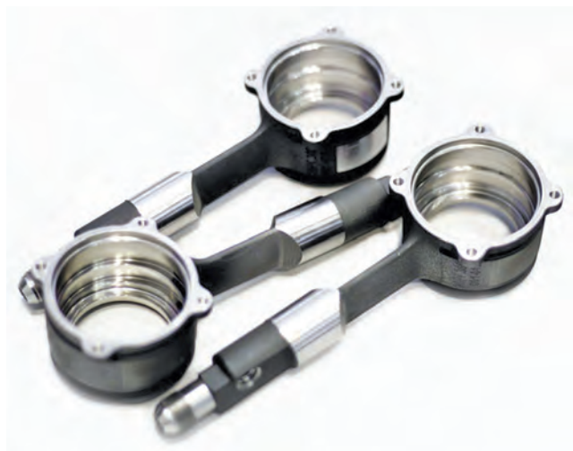
Рис. 3. ДСЕ «Горелочное устройство», изготовленное по ТП СЛС ВЖ159
