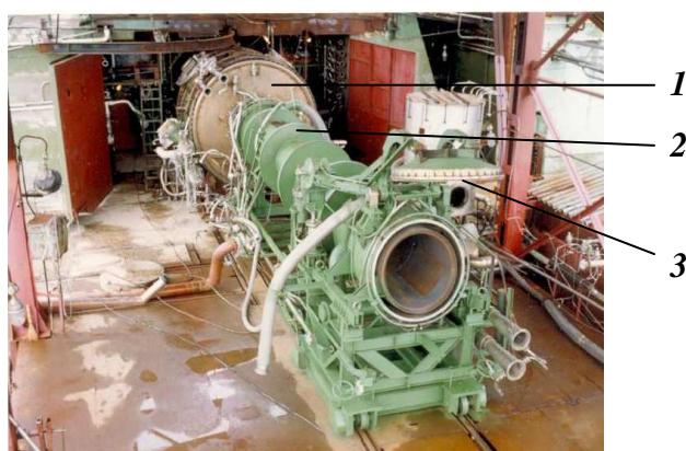
Рис. 2.2. Система имитации высотных условий для отработки двигателя КВД1 на стенде НИЦ РКП:
