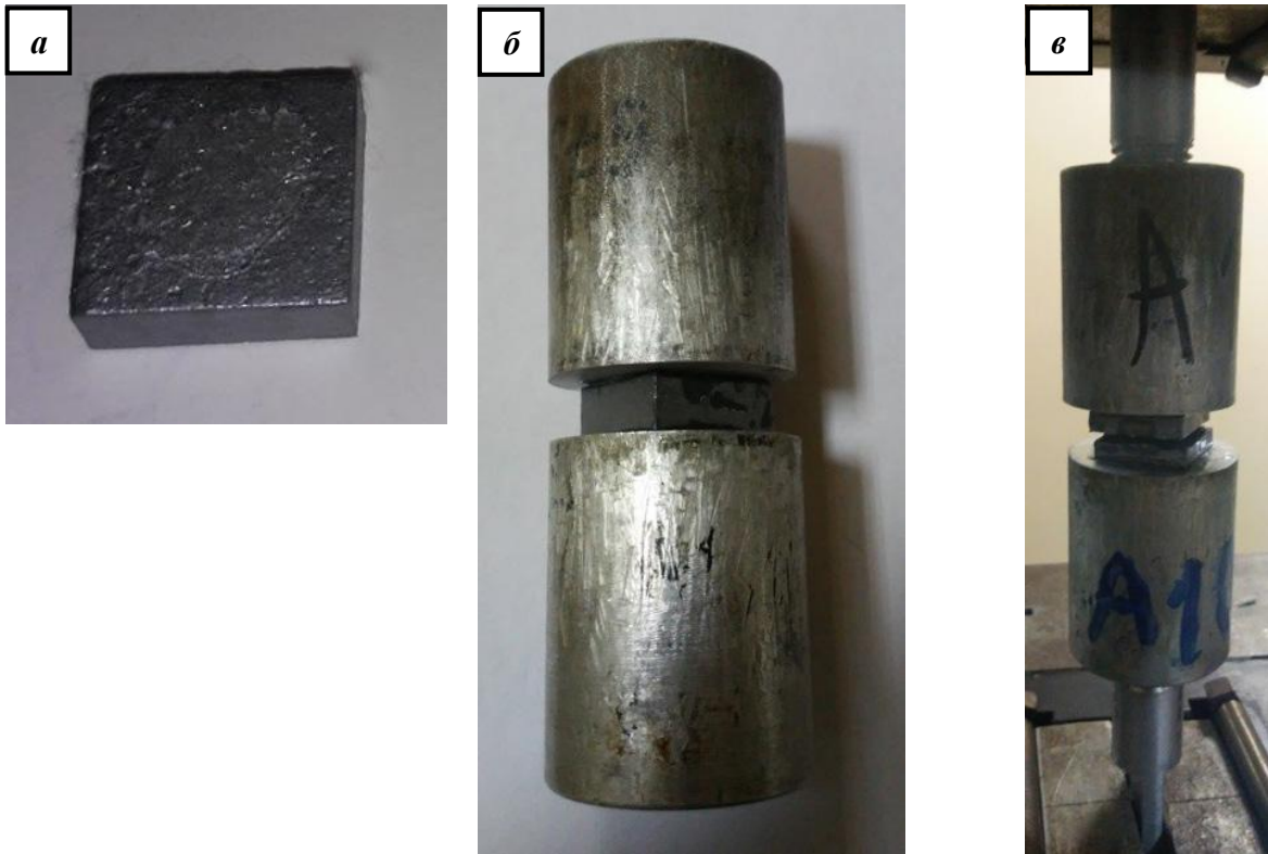
Рис. 5.11. Внешний вид образца на разных этапах испытания: a – исходное состояние, б – образец приклеен к оснастке, в – образец разрушен по основному материалу
