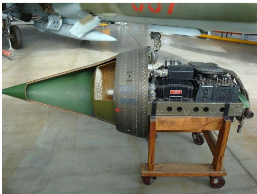
Рис.1.2 – Компоновка БРЭО в НЧФ самолета МИГ-21
