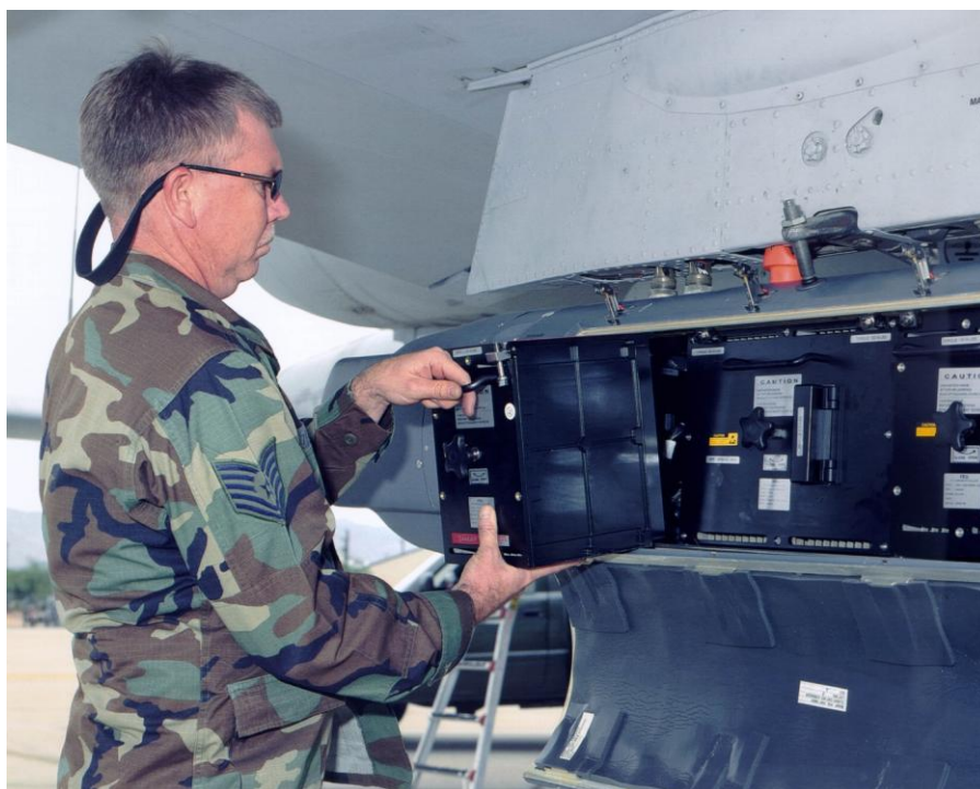
Рис. 1.5 – Процесс обслуживания контейнера litening
