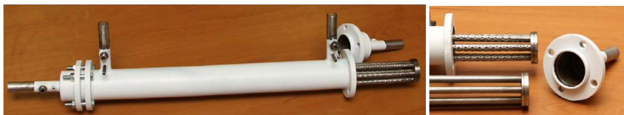
Рис.13. Внешний вид интенсифицированного и гладкотрубного кожухотрубного теплообменного аппарата
