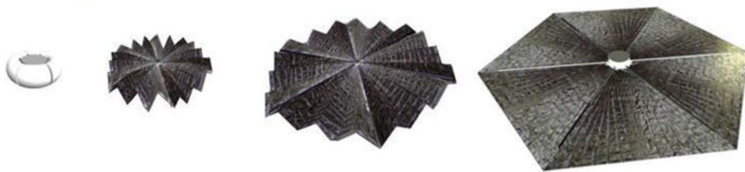
Рисунок 7. Схема космической солнечной электростанции с гибкими пленочными фотопреобразователями (а) и схема раскрытия тонкопленочной фотопреобразующей структуры (б).
