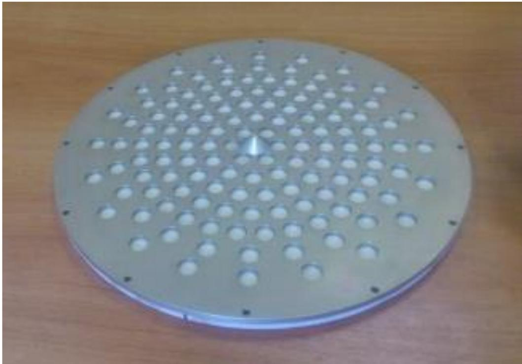
Рис.127. Фотография антенного полотна с согласующим устройством.
