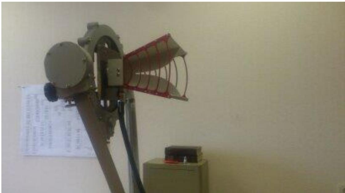
Рис.132. Эталонная широкополосная антенна измерительного комплекса.
