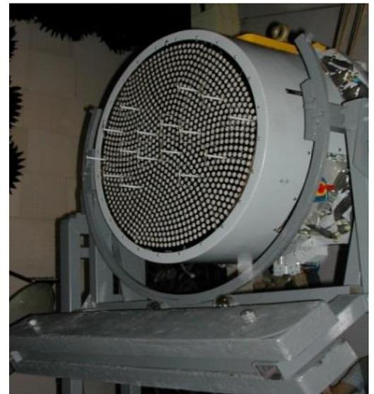
Рис.93. Опытные образцы антенных решеток, возбуждаемых радиальным волноводом.
