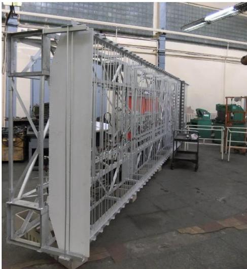
Рис.84. Антенная система модуля вторичного радиолокатора, стадия сборки.
