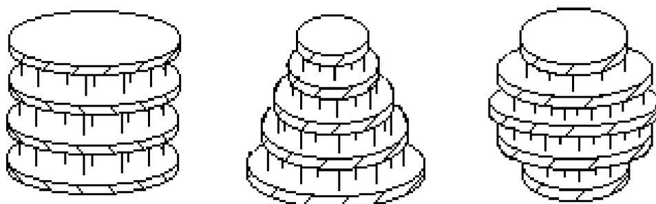
Рис.4. Модели ФАР с двумерным сканированием.
