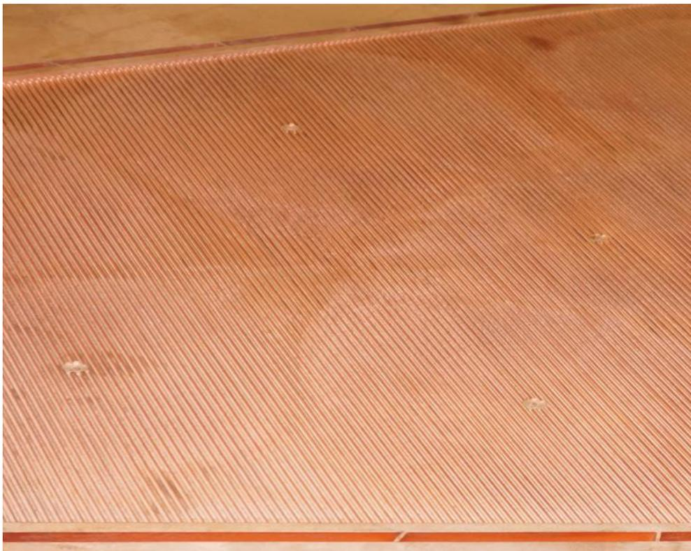
Рис.164. Фрагмент замедляющей структуры.
