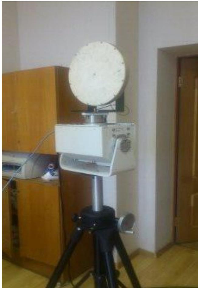
Рис.131. Антенна на измерительном стенде.
