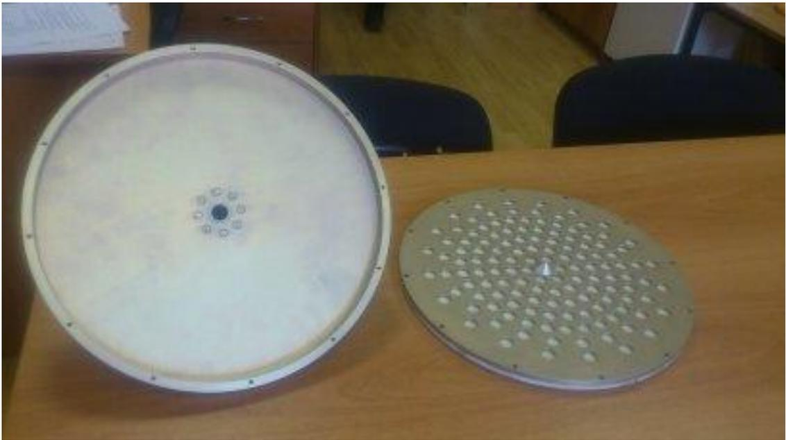
Рис.129. Способ крепления возбуждителя к распределительной системе на РВ.
