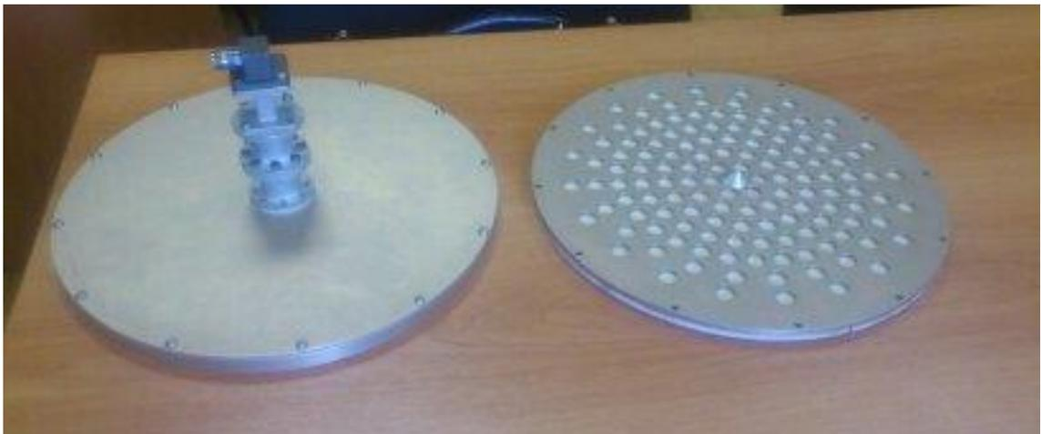
Рис.128. Элементы антенной решетки, совмещенные с системой возбуждения.
