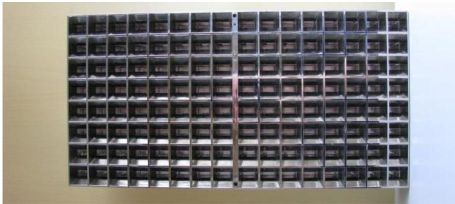
Рис.140. Фотография антенного полотна рупорной антенной решетки, выполненной методом гальванопластики.
