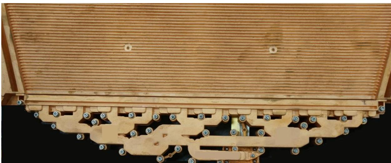
Рис.170. Распределительная система низкопрофильного антенного модуля спутниковой связи сантиметрового диапазона волн с электронно-механическим формированием диаграммы направленности
