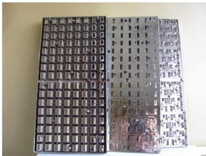
Рис.141. Фотография фрагментов антенного полотна и распределительной системы рупорной антенной решетки.
