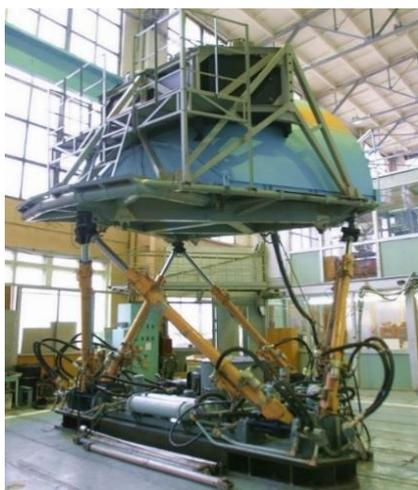
Рисунок 1 - Пилотажный стенд с подвижной кабиной ПСПК-102
