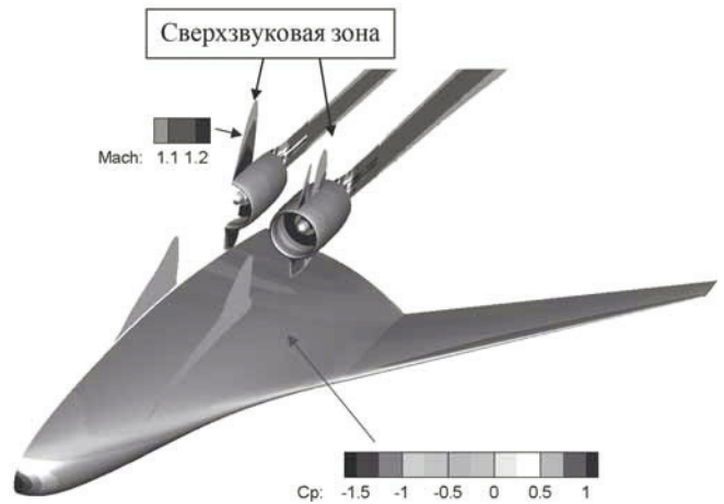
Рис. 10. Обтекание BWB с оптимальным расположением двигателей: распределение коэффициента давления C_p — на поверхности, область M > 1 в потоке. M = 0.85 , \alpha = 2.33^\circ
