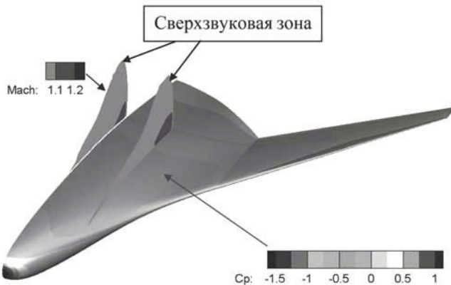
Рис. 8. Обтекание планера BWB: распределение коэффициента давления C_p — на поверхности, область M > 1 в потоке. M = 0.85 , \alpha = 2^\circ
