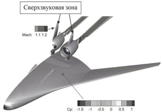
Рис. 9. Обтекание BWB с базовым расположением двигателей: распределение коэффициента давления C_p — на поверхности, область M > 1 в потоке. M = 0.85 , \alpha = 2^\circ
