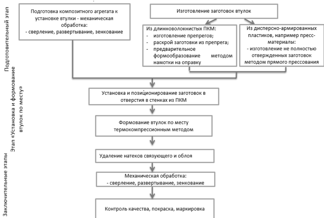
Рисунок 4– Блок-схема, укрупненно отражающая технологический процесс установки композитной втулки термокомпрессионным методом
