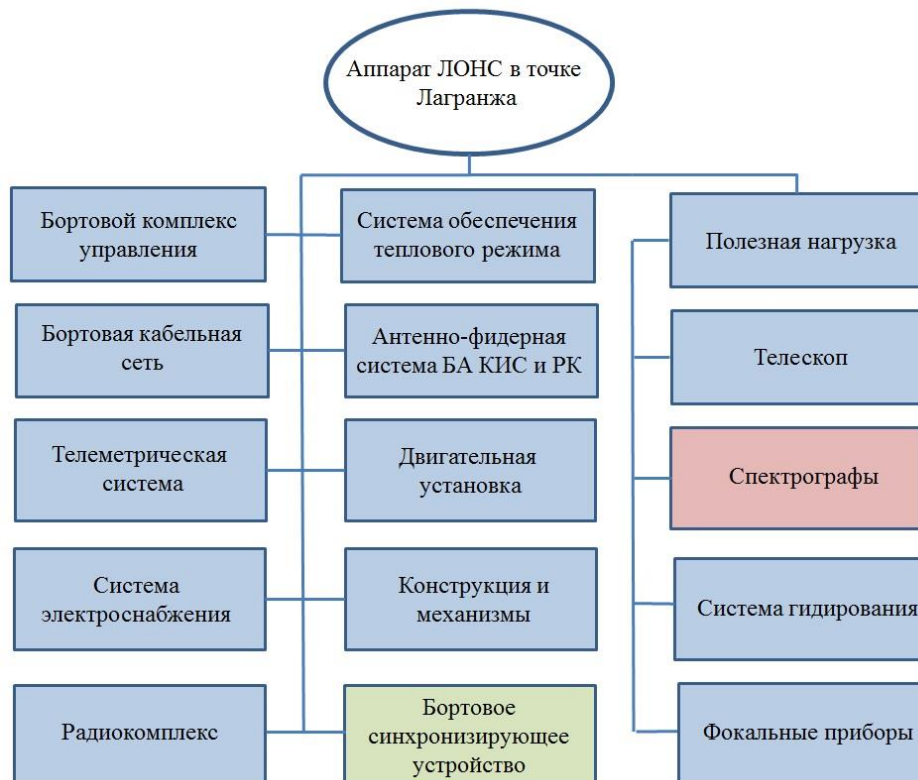
Рисунок 4.4 – Схема деления КА в точках Лагранжа ЛОНС, основанного на КА «Спектр-УФ»: синим цветом выделены дорабатываемые элементы; красным цветом – удаляемые, зеленым – добавленные.
