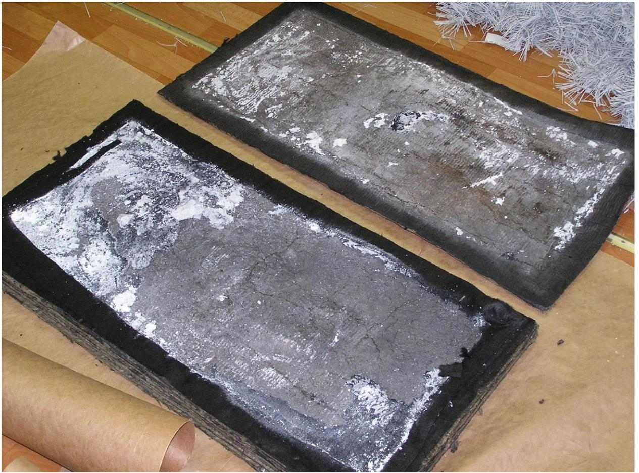
Рисунок 8.7. Разрушенная часть экрана из РПМ на углеродном войлоке. Вверху фотографии – прилегающий слой, подвергшийся термическому воздействию.
