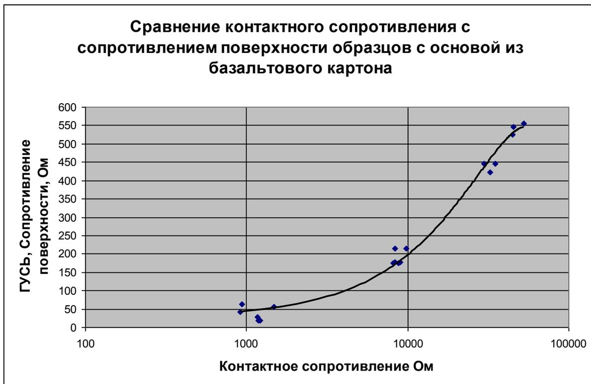
Рисунок 6.8. Данные измерений электрического сопротивления материалов с пропиткой КГР-1700 на базальтовом картоне.
