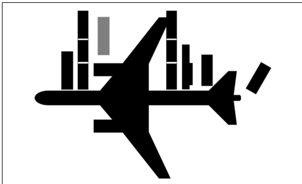
Рис. 5. Карта занятости обслуживания самолета ТУ-204 согласно «Инструкции по организации движения спецтранспорта и средств механизации на гражданских аэродромах РФ»
