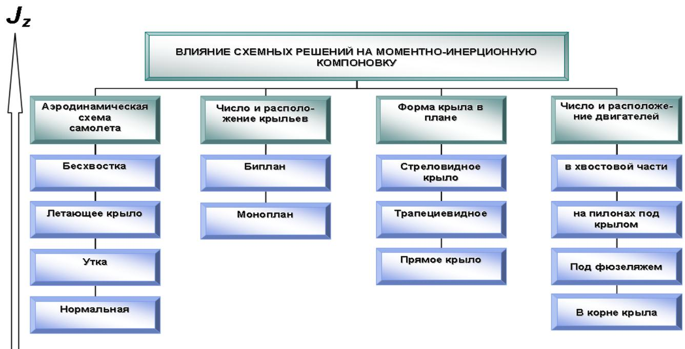
**Рис. 1. Влияние схемных решений на моментно-инерционную компоновку относительно оси OZ**
