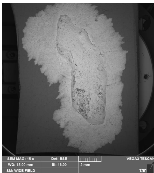
Рисунок 6 - Поверхность сплава АД31 с растекшимся припоем Zn – 4%Al при температуре 420 °С
