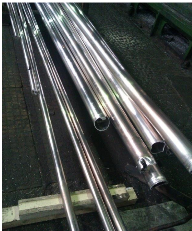
Рис.9 Внешний вид труб, полученных из гранулированного магниевого сплава МА14
