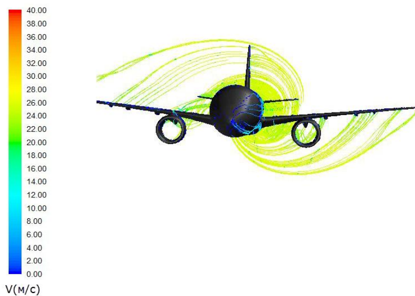
Рисунок 6. Линии тока, полученные по результатам CFD-моделирования аэродинамики с вращением по крену
