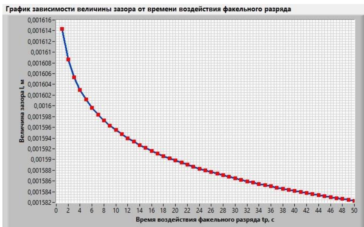
Рис. 7. Зависимость величины зазора от времени воздействия факельного разряда
