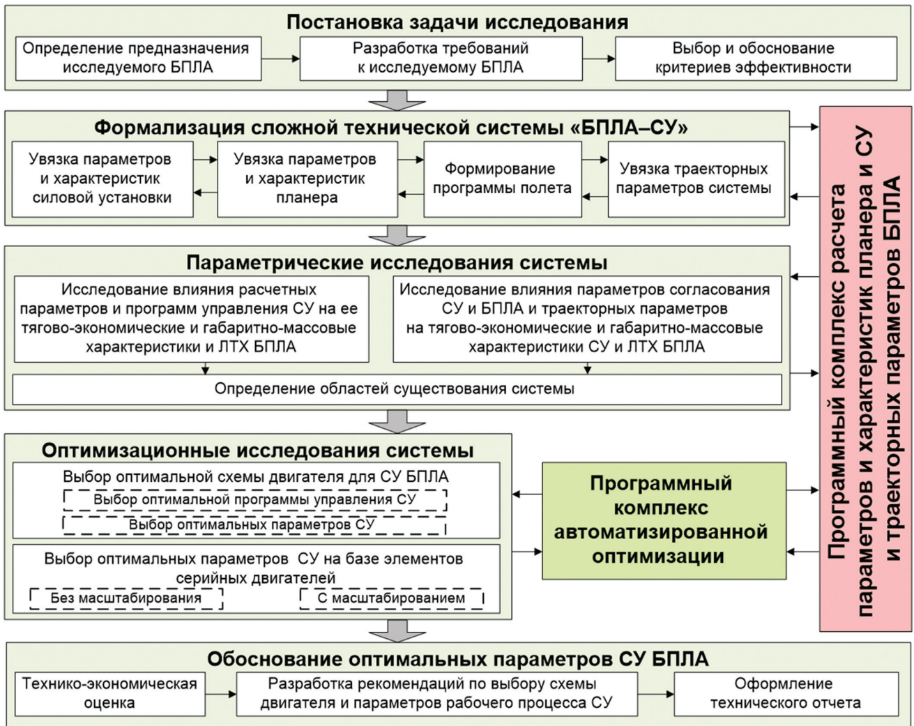
Рис. 2. Блок-схема методики обоснования оптимальных параметров СУ БПЛА
