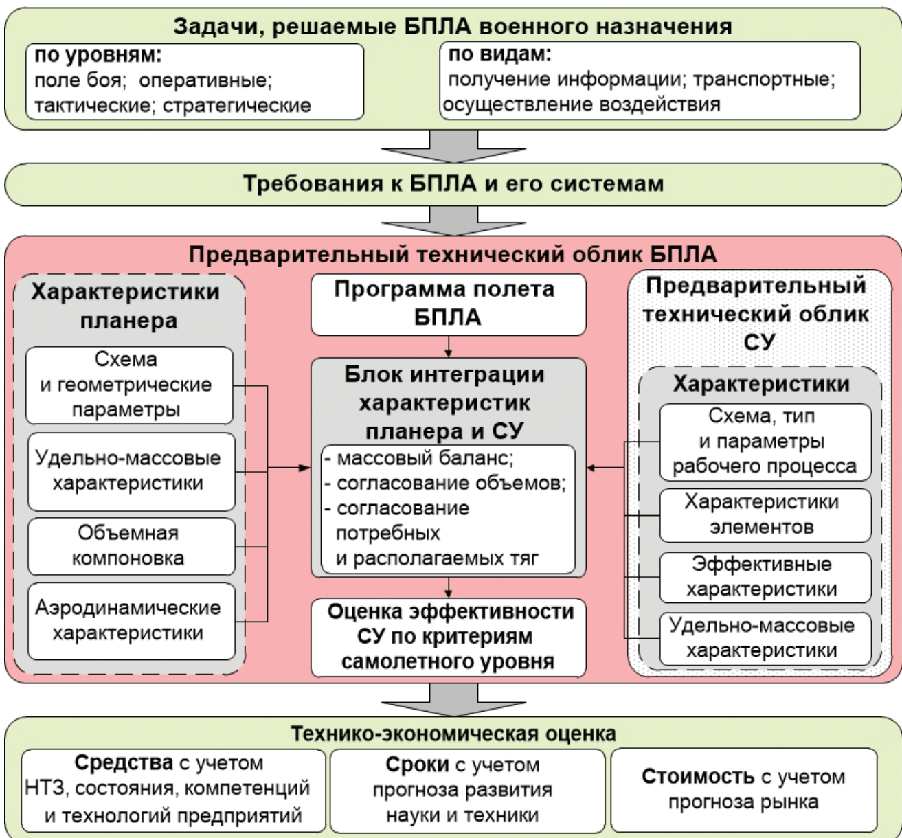
Рис. 1. Блок-схема методологии формирования оптимального технического облика СУ БПЛА военного назначения на этапах предварительного проектирования
