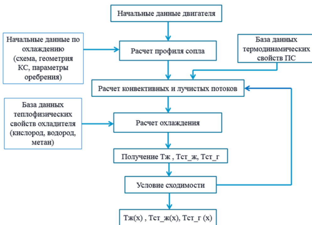
Рисунок 1 – Блок схема расчёта охлаждения двигателя
