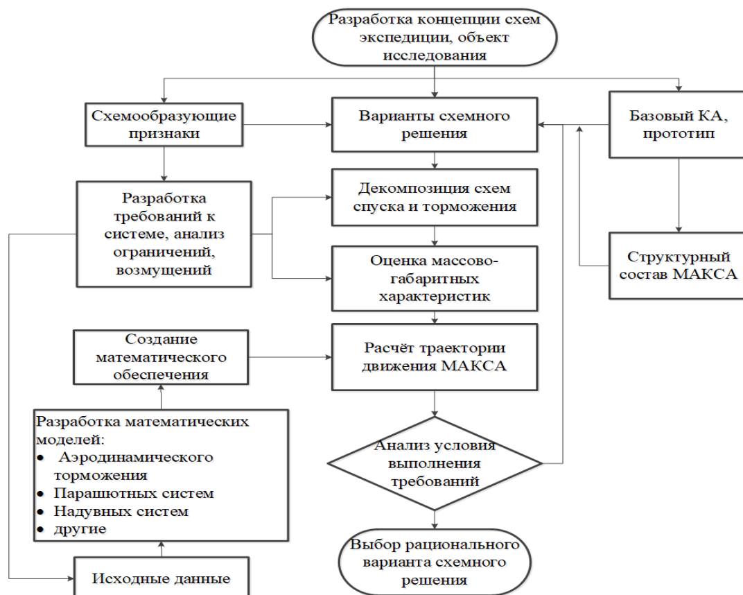
Рис. 1 Алгоритм исследования схемных технических решений
