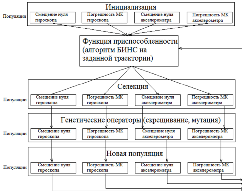
Рисунок 3.18 Схема работы генетического алгоритма. Популяции – дрейфы и погрешности МК гироскопов и акселерометров.
