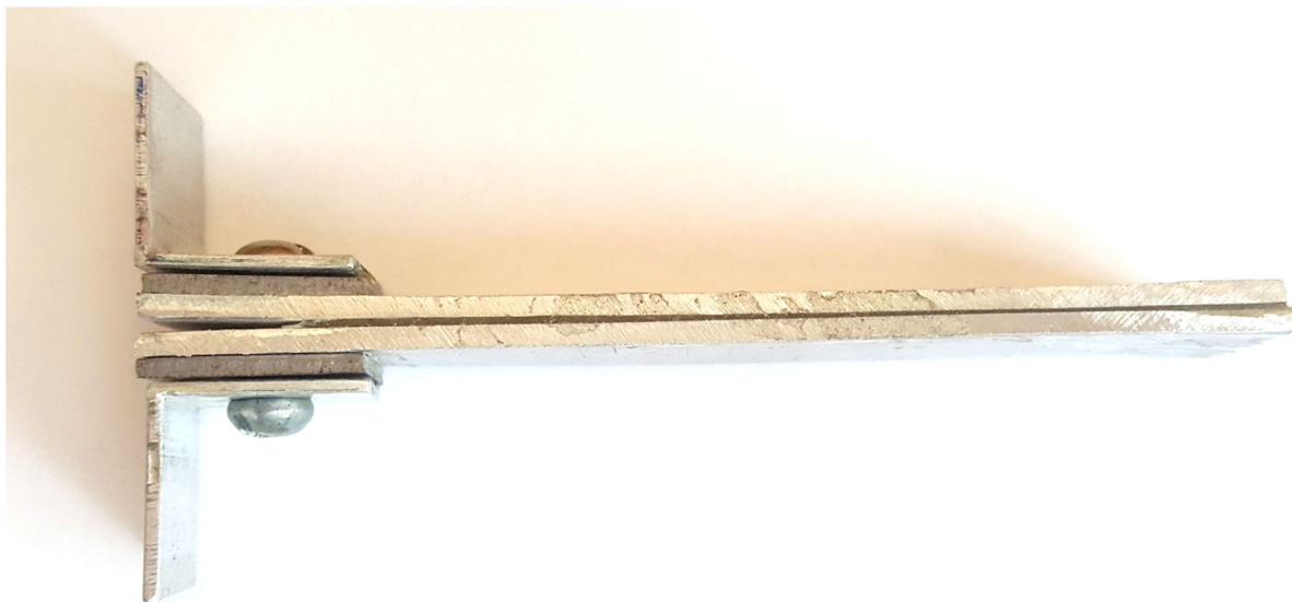
Рисунок 2.2 – Образец типа ДКБ для определения G_{IC} .
