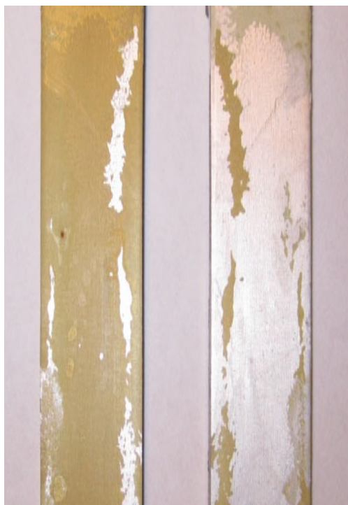
Рисунок 2.4 - Фотографии поверхностей разрушения при нагружении по моде I образцов ККС типа ДКБ на основе клея ВК-9.
