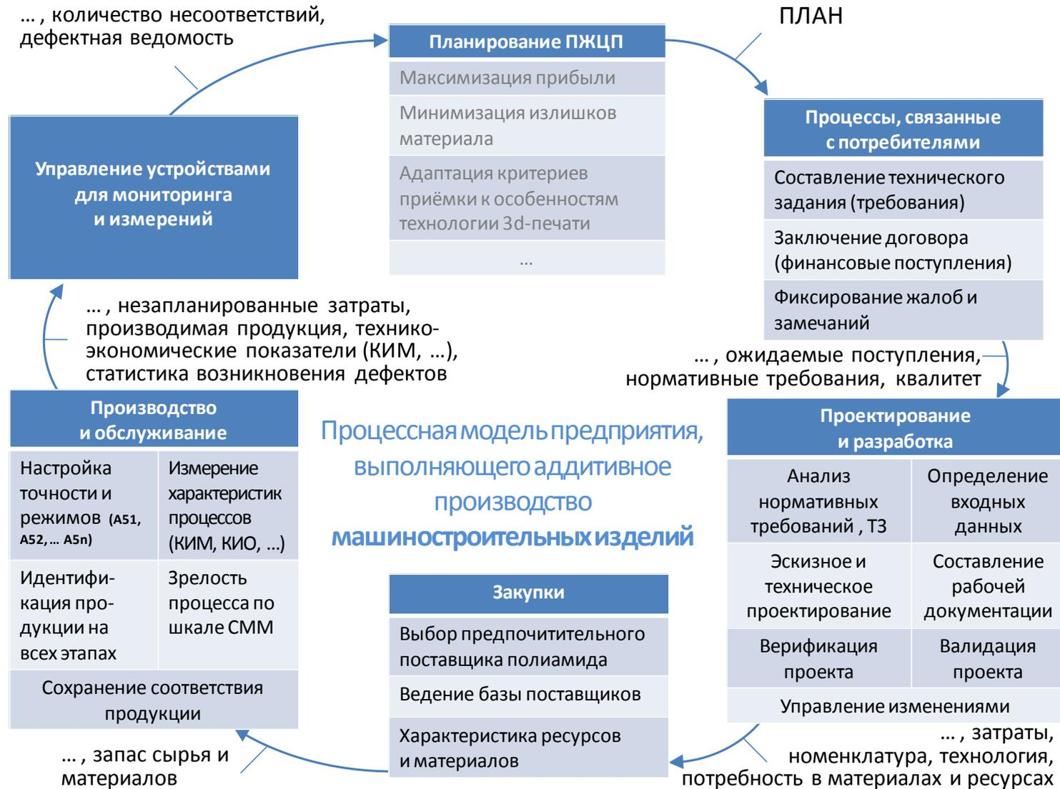
Рисунок 3.8 – Адаптация инвариантной процессной модели ГОСТ Р ИСО 9001 к предприятию аддитивного производства
