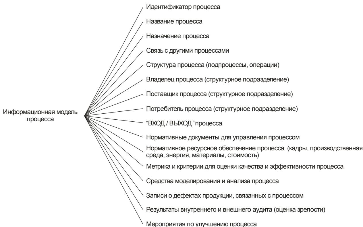
Рисунок 3.3 – Паспорт процесса как основа унифицированного метаописания процессов машиностроительного предприятия
