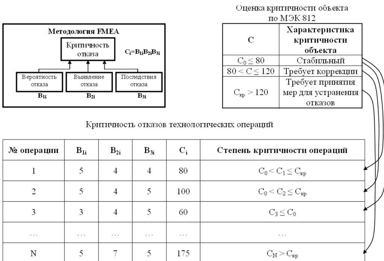
Рисунок 3.6 – Методология FMEA (анализ видов и последствий отказов)
