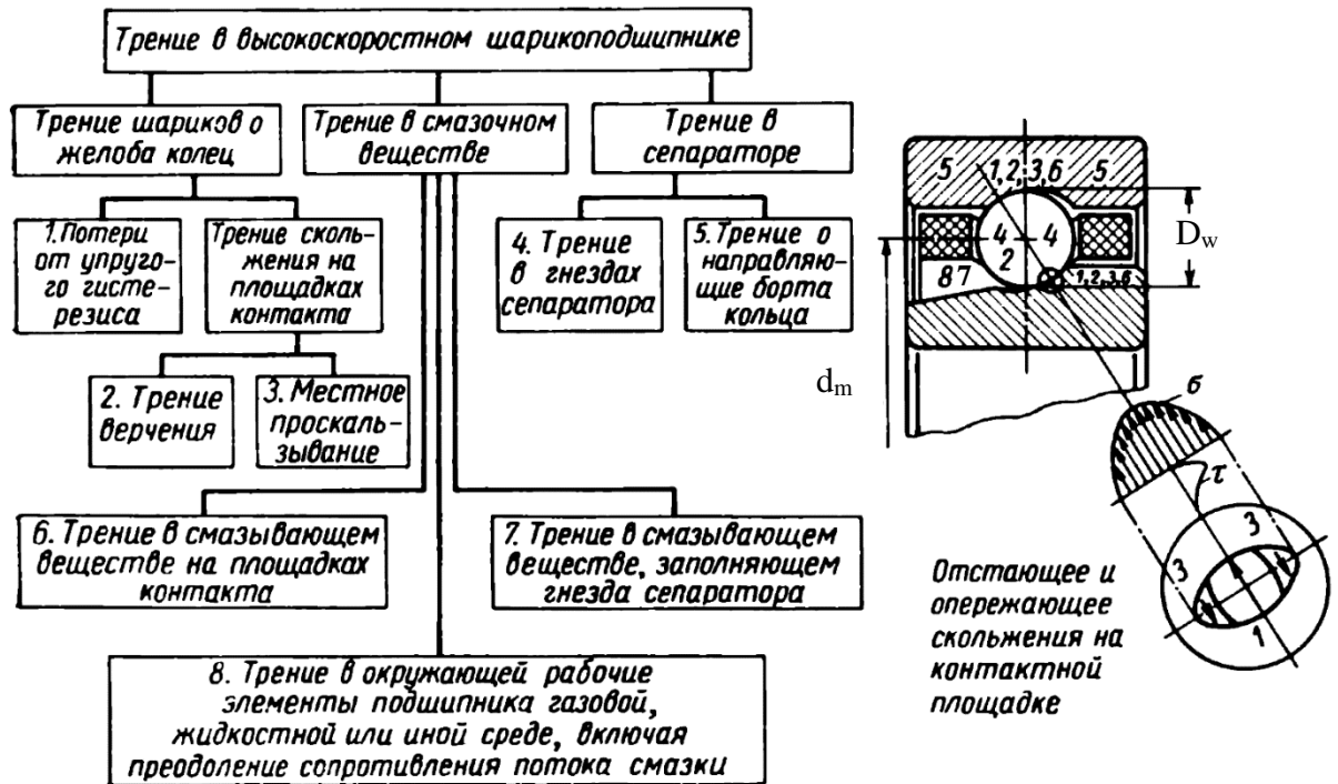
Рисунок 2.2. Составляющие трения в высокоскоростном радиально-упорном шарикоподшипнике [57]
