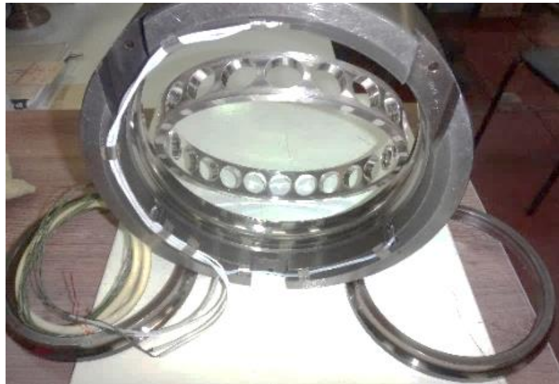
Рисунок 3.13. Установка наружного кольца подшипника в корпус с подводом термодпар к наружному кольцу
