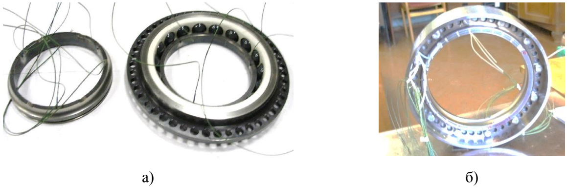
Рисунок 3.4. Препарированные внутренние (а) и наружное (б) кольца подшипника
