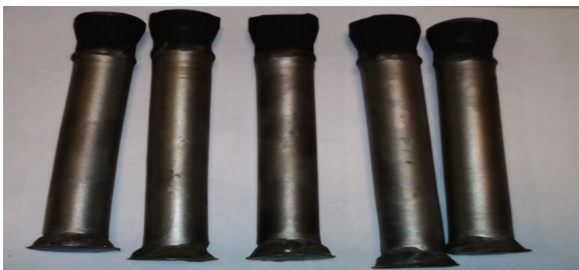
Рисунок 13. Внешний вид части откомпактированных образцов после горячего газостатического прессования.
