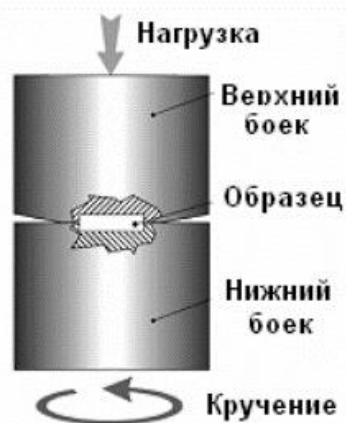
Рисунок 1.1. Схема кручения образца под высоким давлением [20]
