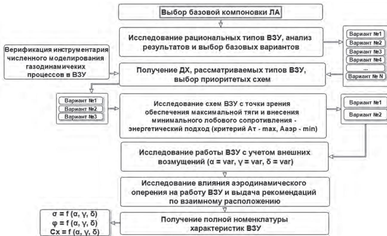
Рис. 15. Блок-схема метода структурно-параметрического синтеза ВЗУ
