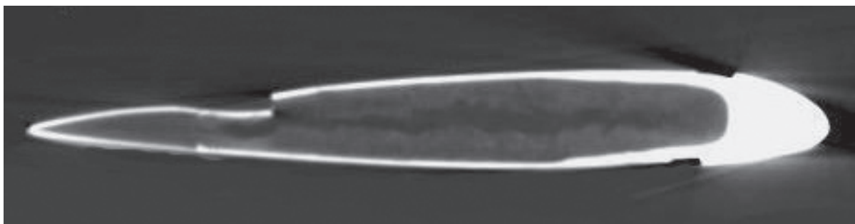
Рис. 14. Компьютерное изображение в зоне ударного повреждения
