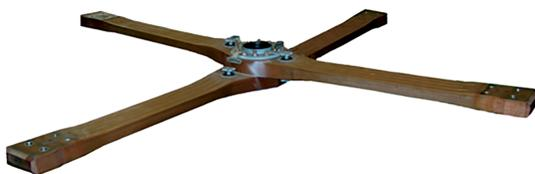
Рис. 1. Втулки несущего винта
