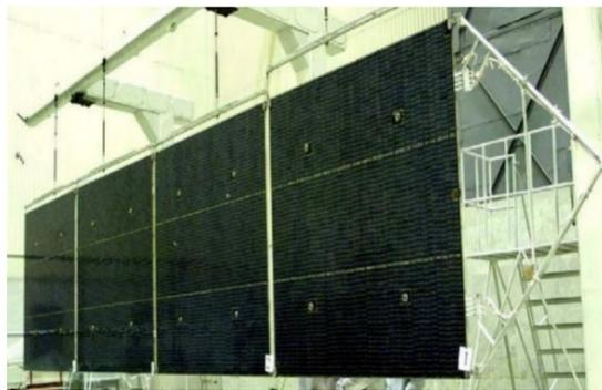
Рисунок 1.6 – БС КА «Ямал-200» на трехслойных сотовых панелях, изготовления ПАО «РКК «Энергия» им. С.П. Королева» [14]
