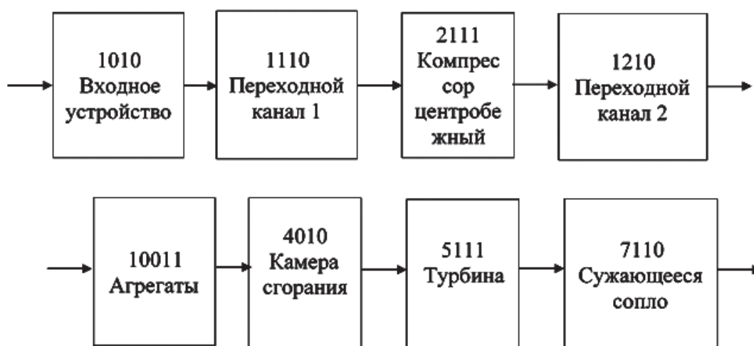
Рис. 2. Расчетная схема ТРД ТЖ-100
