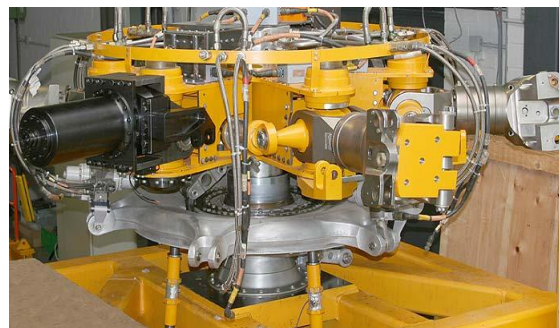
в) втулка НВ с встроенным осевой шарнир двигателем и редуктором
