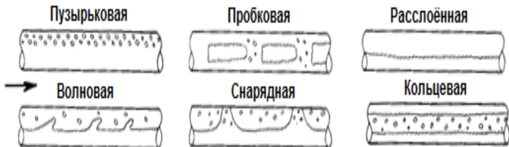
Рисунок 3.8. Основные структуры потоков в горизонтальном трубопроводе
