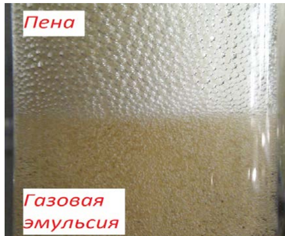
Рисунок 3.17. Иллюстрация процесса определения пенообразующих свойств по ГОСТ 21058-75
