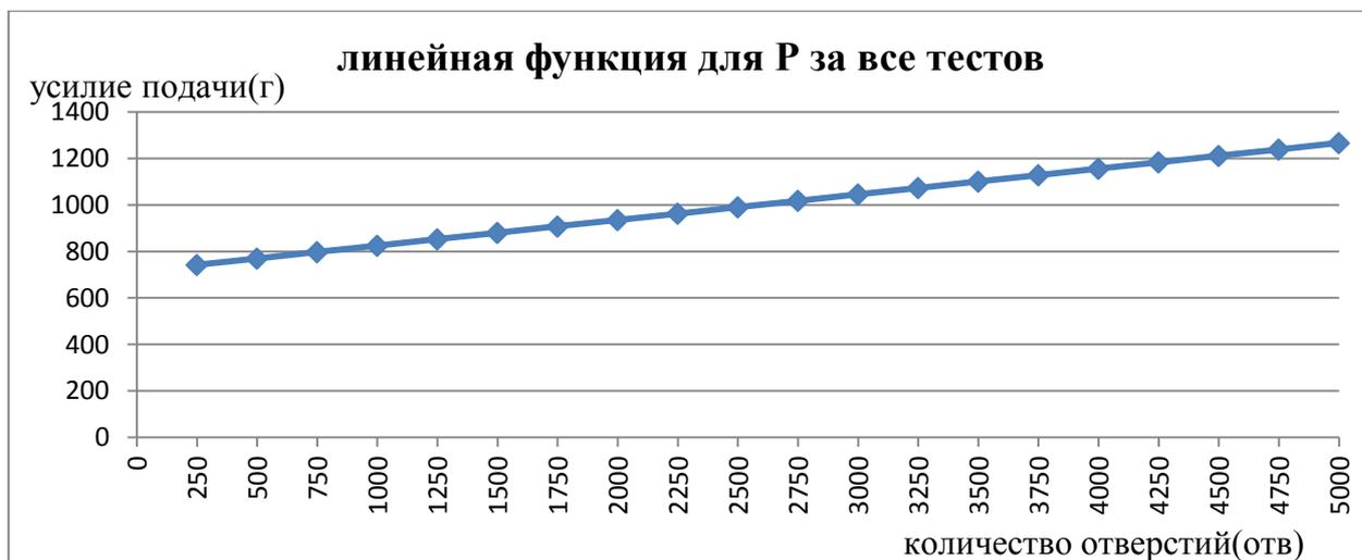
Рис. 6. Суммарная линейризованная экспериментальная зависимость усилия подачи от числа просверленных отверстий.
