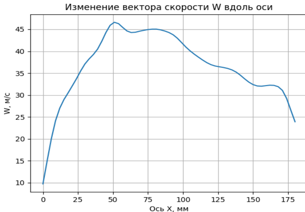
Рисунок 6 – Id 2901, поле вектора скорости вдоль оси при d = 2,3 мм, P_1 = 4,8 , P_\phi = 2,4 атм, P_2 = 4,09 атм
