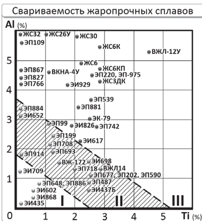
Рис. 3. Диаграмма оценки свариваемости жаропрочных сплавов Cr-Ni по склонности к образованию трещин: I – свариваемые; II – ограниченно свариваемые; III – тяжело свариваемые
