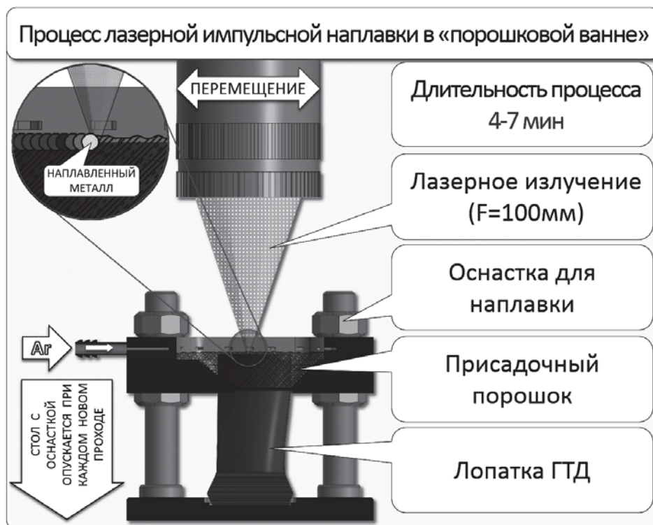
Рис. 6. Процесс лазерной импульсной наплавки в «порошковой ванне» с применением универсальной модульной оснастки
