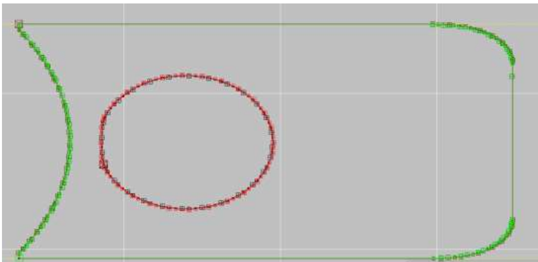
Рисунок 1.22 – Прожиг линии контуров в слое изделия.
