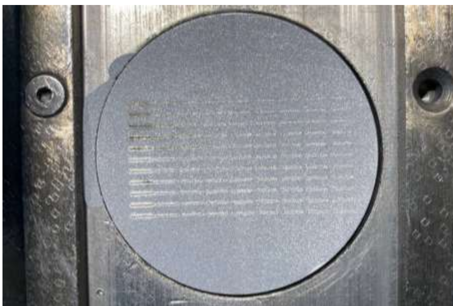
Рисунок 3.6 – Экспонированные треки на платформе установки Addsol D50
