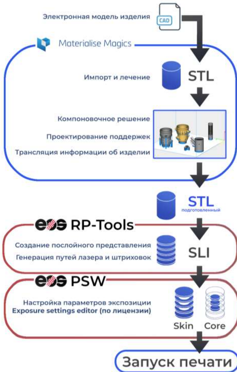
Рисунок 1.25 – Схема процесса подготовки запуска печати в зарубежном ПО.
