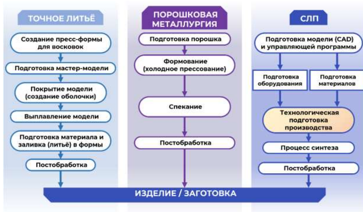
Рисунок 1.8 – Технологические карты процессов литья, порошковой металлургии и селективной лазерной плавки металлопорошковых композиций
