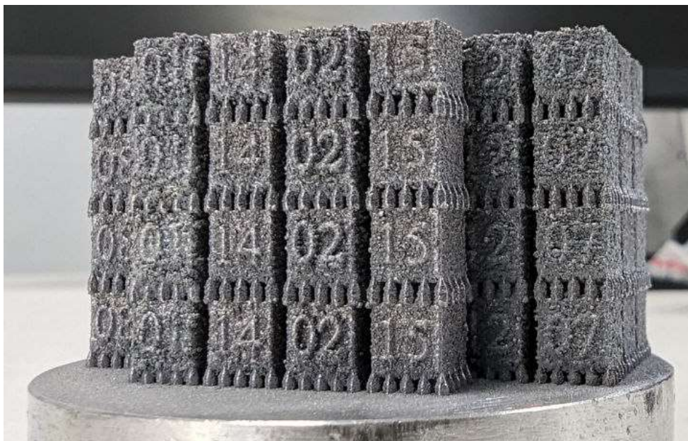
Рисунок 3.12 – Пример размещения «башен» образцов на платформе установки D50
