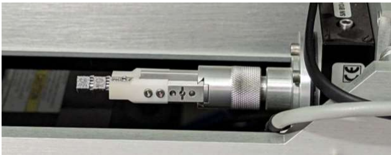
Рисунок 3.14 – Пример установка объёмного образца в зажим томографа
