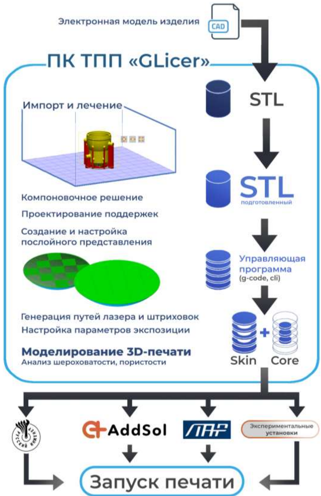
Рисунок 1.39 – Схема процесса подготовки запуска печати в единой информационной среде Glicer.
