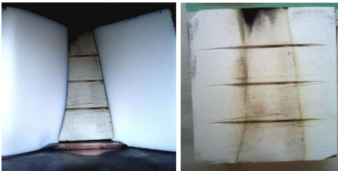
Рис. 106. Внешний вид разрядного канала макета АИПД-95 и его торцевого изолятора без форкамеры.
