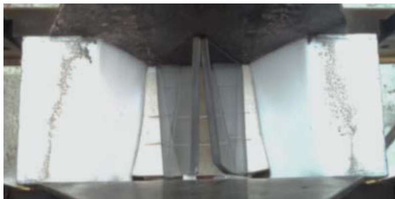
Рис. 93. Эрозия внешних поверхностей шашек РТ при уменьшении длины электродов до 40 мм
