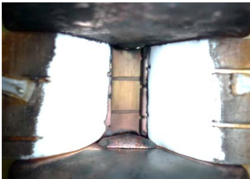
Рис. 81. Внешний вид канала АИПД-70 после приработки шашек
