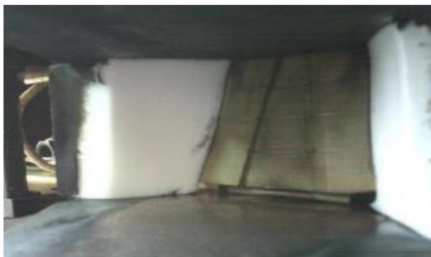
Рис. 88. Внешний вид рабочих поверхностей шашек макета АИПД-95 при a = 26 мм (мощность двигателя 155 Вт)
