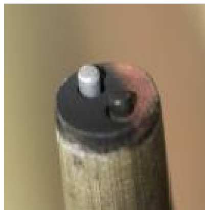
Рис. 96. Свеча поджига после работы в течение 15 минут.
