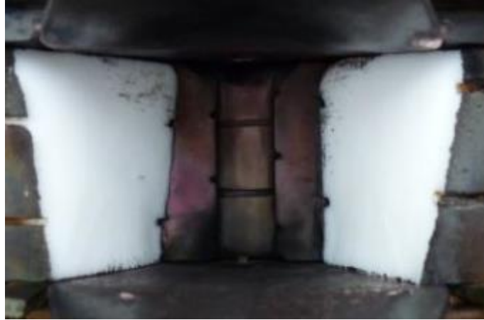
Рис. 84. Внешний вид шашек после работы АИПД-70 без предварительного нагрева шашек при a = 20 мм ( U_p=1200 В, f=1 Гц, T_{ш0}=24^{\circ}\text{C} )
