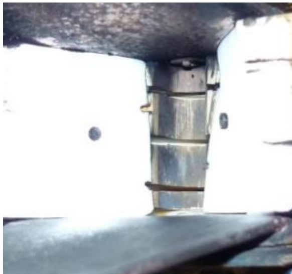
Рис. 100. Внешний вид разрядного канала лабораторной модели АИПД-70, утановлен торцевой изолятор с форкамерой глубиной 12 мм.
