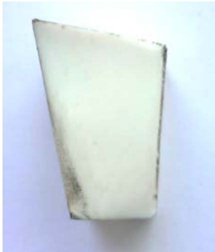
Рис. 73. Шашка рабочего тела АИПД с локальным расположением зоны углеродного налета
