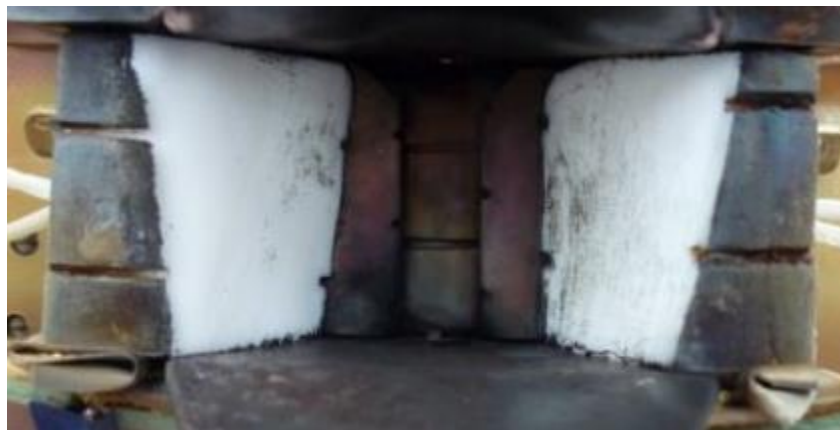
Рис. 85. Внешний вид шашек после работы АИПД-70 с предварительным нагревом шашек до 80^{\circ}\text{C} при a = 20 мм ( U_p=1200 В, f=2 Гц)
