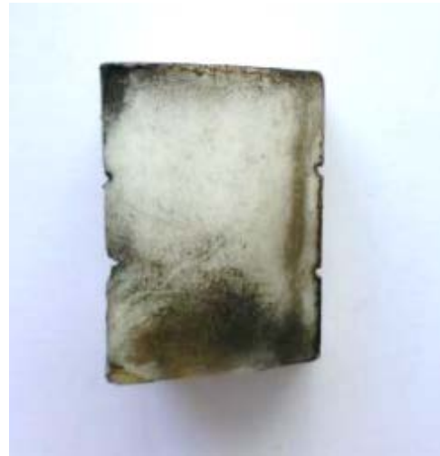
Рис. 74. Шашка рабочего тела АИПД с углеродным налетом, занимающим большую часть ее поверхности
