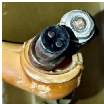
Рис. 94. Науглероженная свеча поджига
