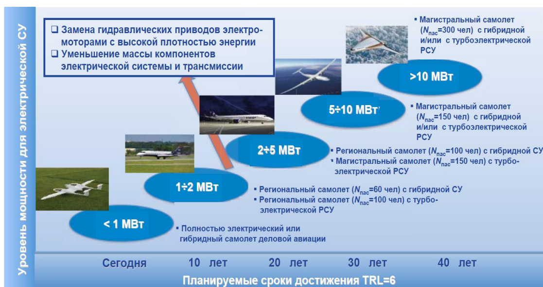
Рисунок В.3 – Этапы разработки гибридных двигателей для силовых установок перспективных пассажирских самолетов NASA [17]
