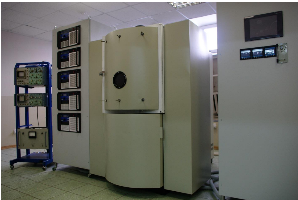
Рисунок 7. Установка магнетронного напыления с замкнутым полем УВМ-700-4М.
