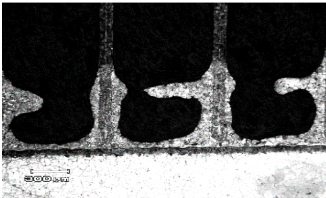
Рисунок 3.1 – Наплыв припоя в виде козырька в ячейке сотового уплотнения
