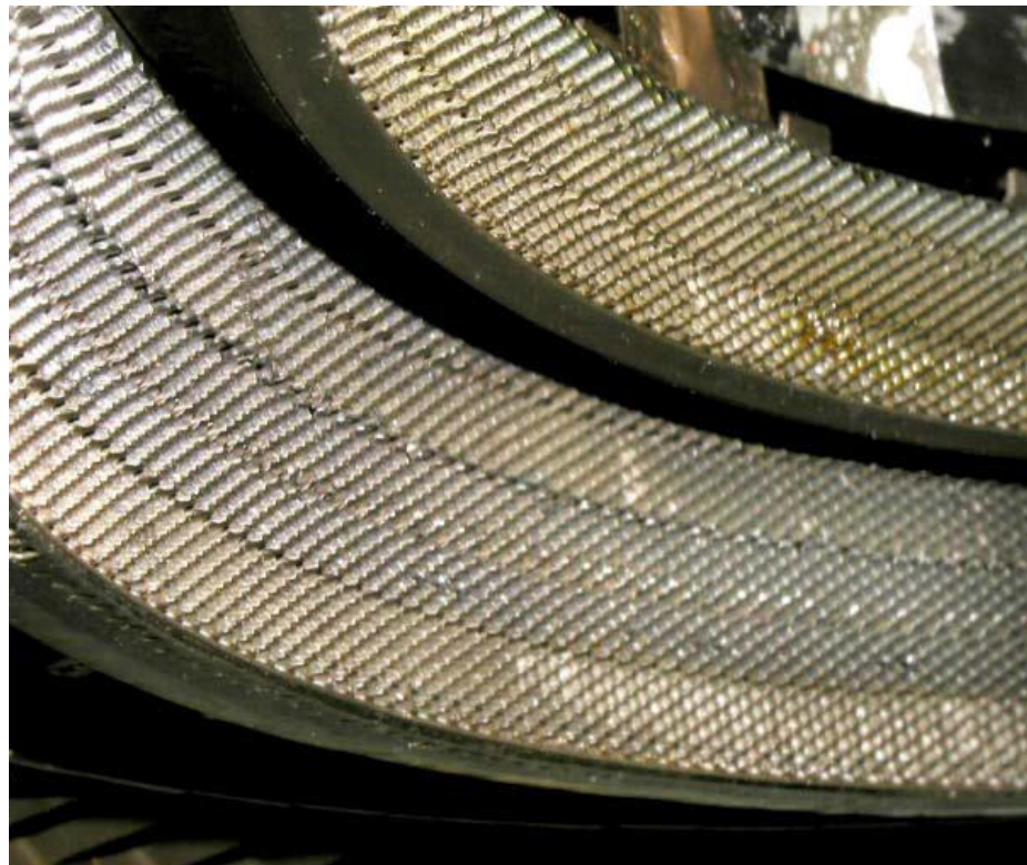
Рисунок 1.2 – Сотовое покрытие статорной части лабиринтного уплотнения
