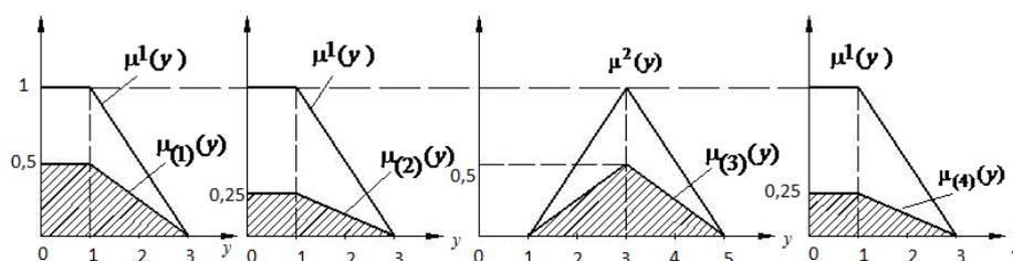
Рис.15. Функции принадлежности всех выводимых множеств ( $*$   $\leftrightarrow$  “алгебраическое произведение”)
