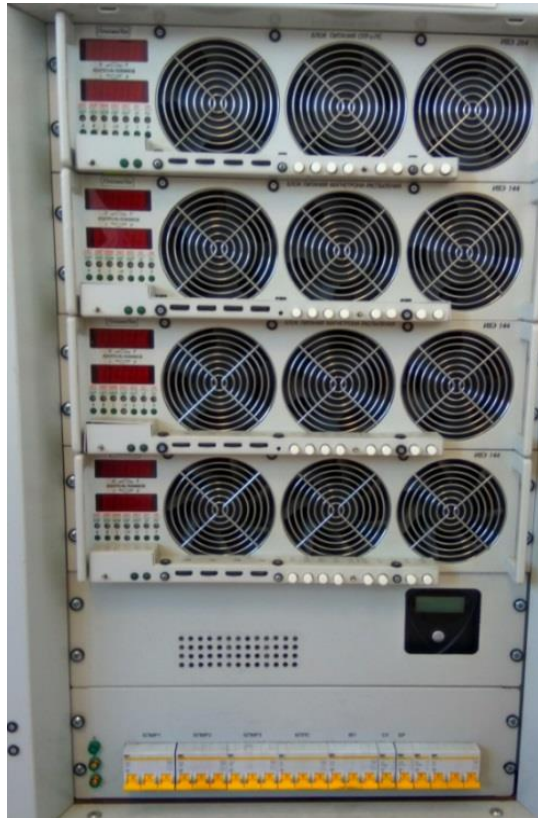
Рисунок 27. Источники питания магнетронов установки МРМ-1.
