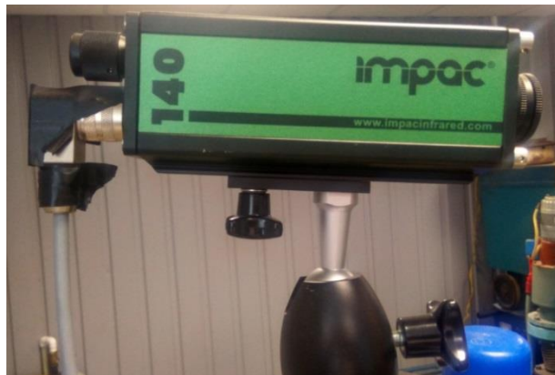
Рисунок 28. Устройство для определения температуры Ипрас-140.
