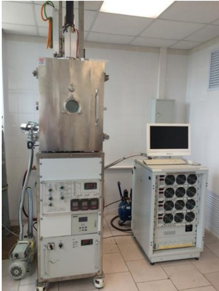
Рисунок 25. Общий вид специализированной установки магнетронного напыления МРМ-1.
