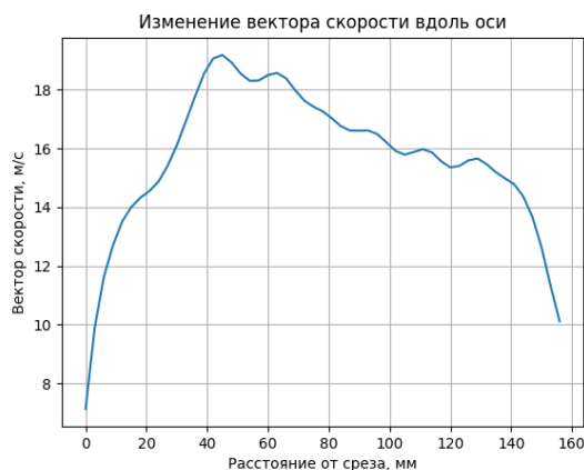
Рисунок 4.2.21 – Id 2404, изменение вектора скорости вдоль оси при d = 4,3 мм, P_1 = 2,1 , P_\phi = 0,2 атм, P_2 = 1,2 атм
