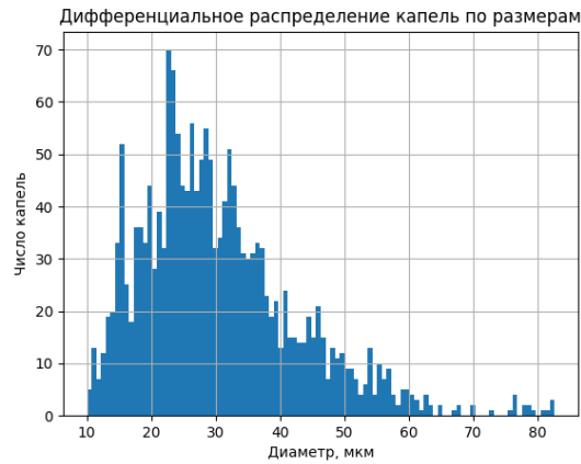
Рисунок 5.2.31 – Id 140806, дифференциальное распределение капель по размерам при d = 2,9 мм, \Pi_1 = 1,07 , P_\phi = 5,3 атм, L = 420 мм, w = 28 м/с, d_{32} = 41 мкм
