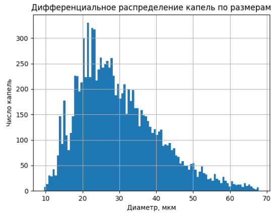
Рисунок 5.2.67 – Id 90806, дифференциальное распределение капель по размерам при d = 1 мм, \Pi_1 = 2,31 , P_\phi = 8,8 атм, L = 150 мм, w = 36 м/с, d_{32} = 38 мкм
