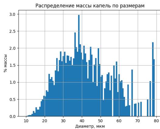
Рисунок 5.2.45 – Id 140808, распределение капель по размерам при d = 2,9 мм, \Pi_1 = 0,95 , P_\phi = 5,8 атм, L = 280 мм, w = 47 м/с, d_{32} = 38 мкм
