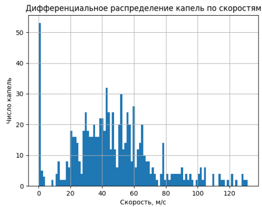
Рисунок 5.2.53 – Id 140809, дифференциальное распределение капель по скоростям при d = 2,9 мм, \Pi_1 = 0,61 , P_\phi = 7,1 атм, L = 280 мм, w = 35 м/с, d_{32} = 37 мкм
