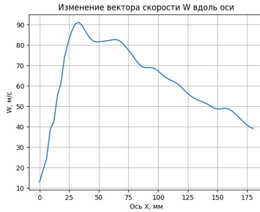
Рисунок 4.2.9 – Id 2903, поле вектора скорости вдоль оси при d = 2,3 мм, \Pi_1 = 2 , P_\phi = 5,8 атм, P_2 = 8,18 атм
