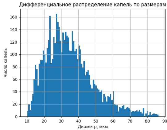
Рисунок 5.2.19 – Id 140804, дифференциальное распределение капель по размерам d = 2,9 мм, \Pi_1 = 1 , P_\phi = 3,9 атм, L = 400 мм, w = 31 м/с, d_{32} = 47 мкм
