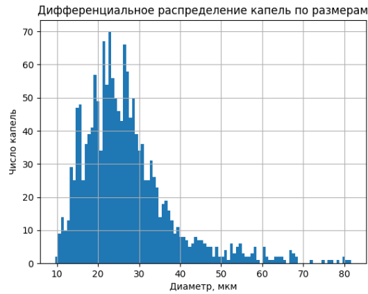
Рисунок 5.2.49 – Id 140809, дифференциальное распределение капель по размерам при d = 2,9 мм, \Pi_1 = 0,61 , P_\phi = 7,1 атм, L = 280 мм, w = 35 м/с, d_{32} = 37 мкм
