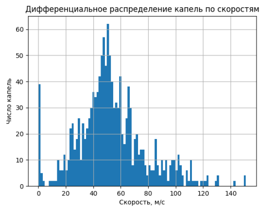
Рисунок 5.2.47 – Id 140808, дифференциальное распределение капель по скоростям при d = 2,9 мм, \Pi_1 = 0,95 , P_\phi = 5,8 атм, L = 280 мм, w = 47 м/с, d_{32} = 38 мкм
