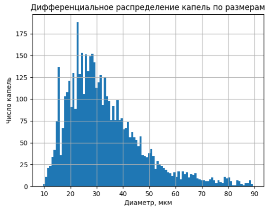
Рисунок 5.2.55 – Id 140810, дифференциальное распределение капель по размерам при d = 2,9 мм, \Pi_1 = 1,86 , P_\phi = 4,2 атм, L = 280 мм, w = 38 м/с, d_{32} = 46 мкм
