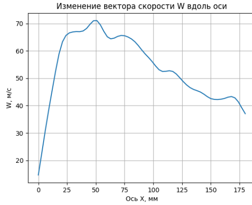
Рисунок 4.2.6 – Id 2902, изменение вектора скорости вдоль оси при d = 2,3 мм, P_1 = 2,9 , P_\phi = 4,2 атм, P_2 = 6,26 атм
