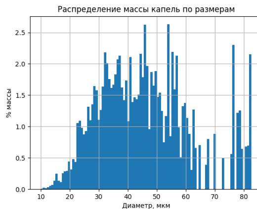
Рисунок 5.2.33 – Id 140806, распределение капель по размерам при d = 2,9 мм, \Pi_1 = 1,07 , P_\phi = 5,3 атм, L = 420 мм, w = 28 м/с, d_{32} = 41 мкм
