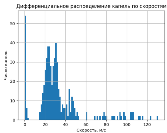
Рисунок 5.2.11 – Id 140802, дифференциальное распределение капель по скоростям при d = 2,9 мм, \Pi_1 = 0,57 , P_\phi = 6,8 атм, L = 400 мм, w = 18 м/с, d_{32} = 39 мкм
