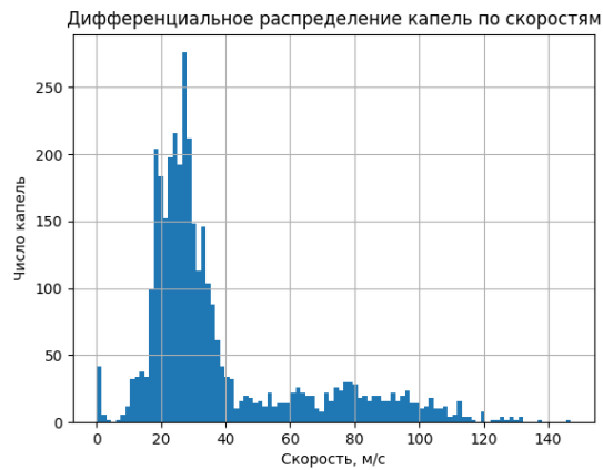
Рисунок 5.2.23 – Id 140804, дифференциальное распределение капель по скоростям при d = 2,9 мм, \Pi_1 = 1 , P_\phi = 3,9 атм, L = 400 мм, w = 31 м/с, d_{32} = 47 мкм
