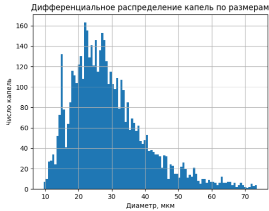
Рисунок 5.2.1 – Id 140801, дифференциальное распределение капель по размерам при d = 2,9 мм, \Pi_1 = 0,94 , P_\phi = 5,2 атм, L = 280 мм, d_{32} = 38 мкм
