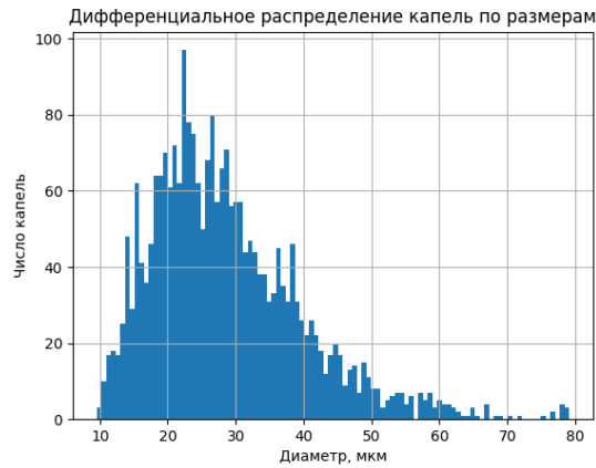
Рисунок 5.2.43 – Id 140808, дифференциальное распределение капель по размерам при d = 2,9 мм, \Pi_1 = 0,95 , P_\phi = 5,8 атм, L = 280 мм, w = 47 м/с, d_{32} = 38 мкм
