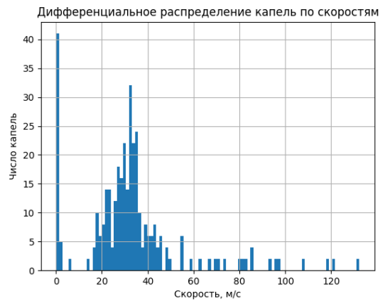
Рисунок 5.2.41 – Id 140807, дифференциальное распределение капель по скоростям при d = 2,9 мм, \Pi_1 = 7 , P_\phi = 0,56 атм, L = 420 мм, w = 20 м/с, d_{32} = 44 мкм
