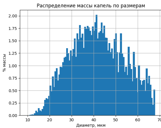
Рисунок 5.2.69 – Id 90806, распределение капель по размерам при d = 1 мм, \Pi_1 = 2,31 , P_\phi = 8,8 атм, L = 150 мм, w = 36 м/с, d_{32} = 38 мкм
