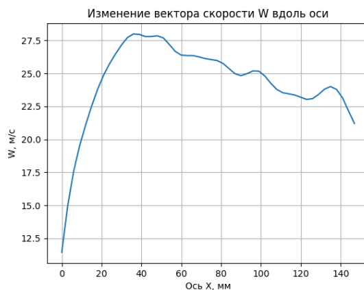
Рисунок 4.2.54 – Id 1810, изменение вектора скорости вдоль оси при d = 1,6 мм, P_1 = 4,5 , P_\phi = 1,4 атм, P_2 = 1,7 атм
