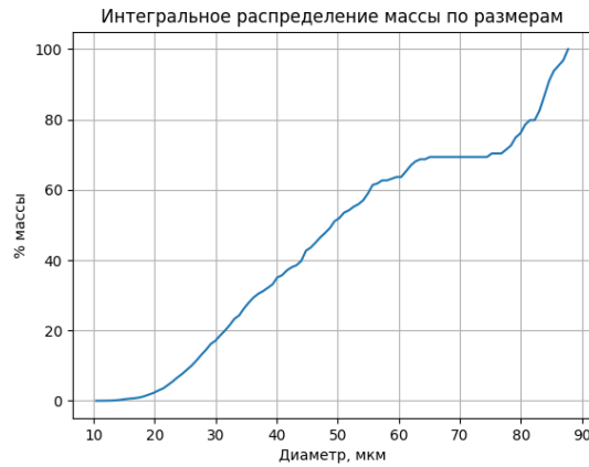
Рисунок 5.2.40 – Id 140807, интегральное распределение капель по размерам при d = 2,9 мм, \Pi_1 = 7 , P_\phi = 0,56 атм, L = 420 мм, w = 20 м/с, d_{32} = 44 мкм
