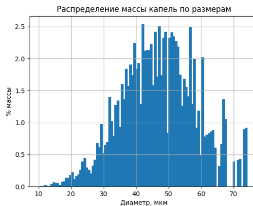
Рисунок 5.2.75 – Id 90807, распределение капель по размерам при d = 1 мм, \Pi_1 = 4,34 , P_\phi = 8,1 атм, L = 150 мм, w = 34 м/с, d_{32} = 44 мкм
