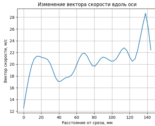
Рисунок 4.2.33 – Id 2411, изменение вектора скорости вдоль оси при d = 2,9 мм, P_1 = 0,3 , P_\phi = 5,8 атм, P_2 = 8,18 атм
