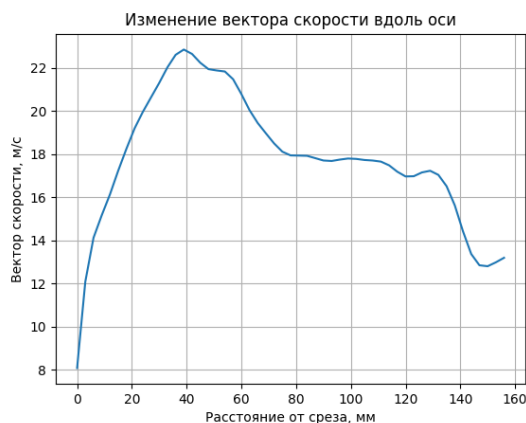
Рисунок 4.2.18 – Id 2403, изменение вектора скорости вдоль оси при d = 4,3 мм, P_1 = 1,5 , P_\phi = 0,3 атм, P_2 = 1,2 атм
