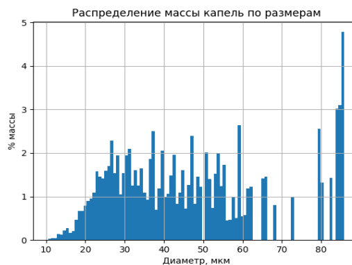
Рисунок 5.2.9 – Id 140802, распределение капель по размерам при d = 2,9 мм, \Pi_1 = 0,57 , P_\phi = 6,8 атм, L = 400 мм, w = 18 м/с, d_{32} = 39 мкм
