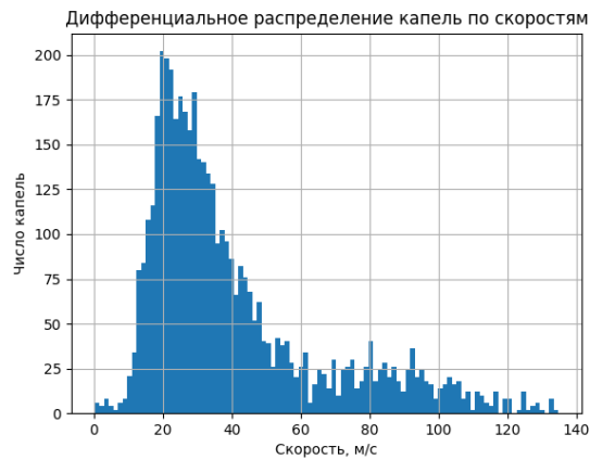
Рисунок 5.2.65 – Id 90805, дифференциальное распределение капель по скоростям при d = 1 мм, \Pi_1 = 1,18 , P_\phi = 9,0 атм, L = 150 мм, w = 35 м/с, d_{32} = 37 мкм
