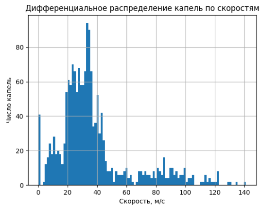
Рисунок 5.2.17 – Id 140803, дифференциальное распределение капель по скоростям при d = 2,9 мм, \Pi_1 = 1 , P_\phi = 5,5 атм, L = 400 мм, w = 31 м/с, d_{32} = 40 мкм
