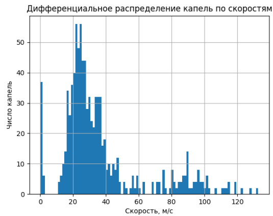
Рисунок 5.2.35 – Id 140806, дифференциальное распределение капель по скоростям при d = 2,9 мм, \Pi_1 = 1,07 , P_\phi = 5,3 атм, L = 420 мм, w = 28 м/с, d_{32} = 41 мкм
