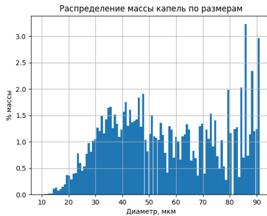
Рисунок 5.2.27 – Id 140805, распределение капель по размерам при d = 2,9 мм, \Pi_1 = 1,44 , P_\phi = 4,4 атм, L = 420 мм, w = 30 м/с, d_{32} = 48 мкм
