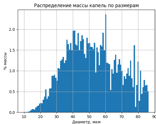
Рисунок 5.2.21 – Id 140804, распределение капель по размерам при d = 2,9 мм, \Pi_1 = 1 , P_\phi = 3,9 атм, L = 400 мм, w = 31 м/с, d_{32} = 47 мкм
