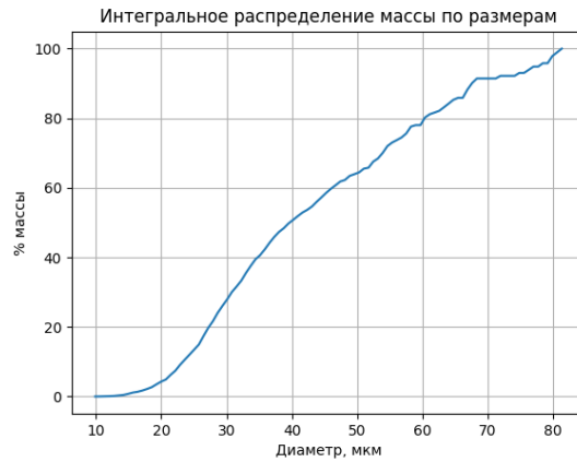
Рисунок 5.2.52 – Id 140809, интегральное распределение капель по размерам d = 2,9 мм, \Pi_1 = 0,61 , P_\phi = 7,1 атм, L = 280 мм, w = 35 м/с, d_{32} = 37 мкм
