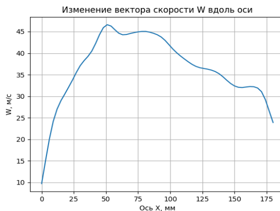
Рисунок 4.2.3 – Id 2901, поле вектора скорости вдоль оси при d = 2,3 мм, \Pi_1 = 4,8 , P_\phi = 2,4 атм, P_z = 4,09 атм
