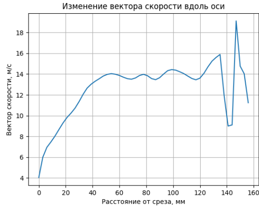
Рисунок 4.2.24 – Id 2405, изменение вектора скорости вдоль оси при d = 4,3 мм, P_1 = 2,9 , P_\phi = 0,2 атм, P_2 = 1,2 атм
