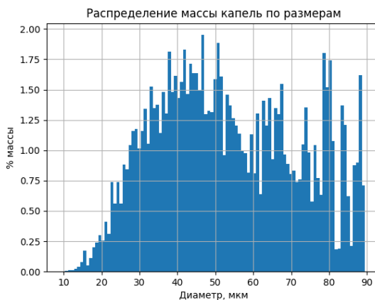
Рисунок 5.2.57 – Id 140810, распределение капель по размерам при d = 2,9 мм, \Pi_1 = 1,86 , P_\phi = 4,2 атм, L = 280 мм, w = 38 м/с, d_{32} = 46 мкм
