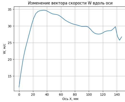
Рисунок 4.2.51 – Id 1809, изменение вектора скорости вдоль оси при d = 1,6 мм, P_1 = 3,5 , P_\phi = 1,9 атм, P_2 = 2,2 атм
