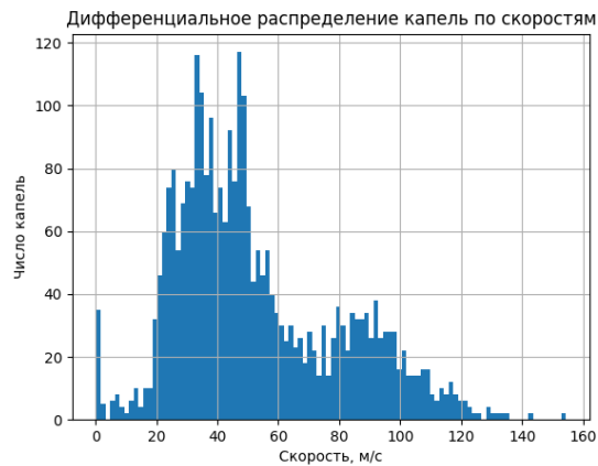
Рисунок 5.2.5 – Id 140801, дифференциальное распределение капель по скоростям при d = 2,9 мм, \Pi_1 = 0,94 , P_\phi = 5,2 атм, L = 280 мм, w = 46 м/с
