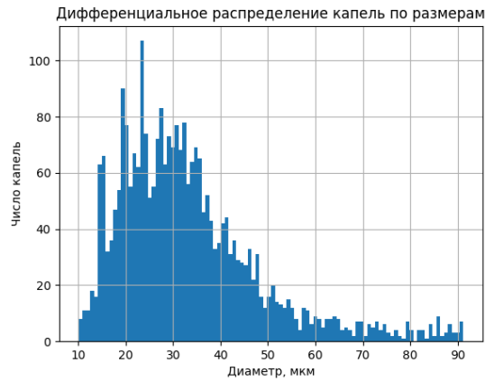
Рисунок 5.2.25 – Id 140805, дифференциальное распределение капель по размерам при d = 2,9 мм, \Pi_1 = 1,44 , P_\phi = 4,4 атм, L = 420 мм, w = 30 м/с, d_{32} = 48 мкм
