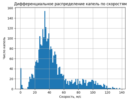
Рисунок 5.2.59 – Id 140810, дифференциальное распределение капель по скоростям при d = 2,9 мм, \Pi_1 = 1,86 , P_\phi = 4,2 атм, L = 280 мм, w = 38 м/с, d_{32} = 46 мкм
