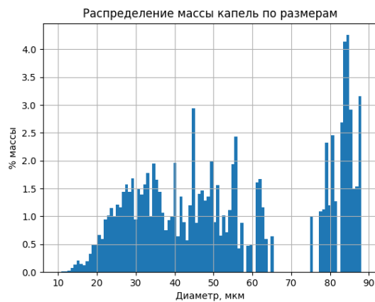
Рисунок 5.2.39 – Id 140807, распределение капель по размерам при d = 2,9 мм, \Pi_1 = 7 , P_\phi = 0,56 атм, L = 420 мм, w = 20 м/с, d_{32} = 44 мкм
