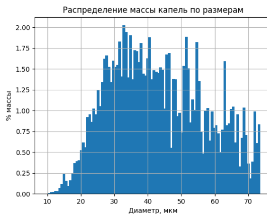
Рисунок 5.2.3 – Id 140801, распределение капель по размерам при d = 2,9 мм, \Pi_1 = 0,94 , P_\phi = 5,2 атм, L = 280 мм, d_{32} = 38 мкм
