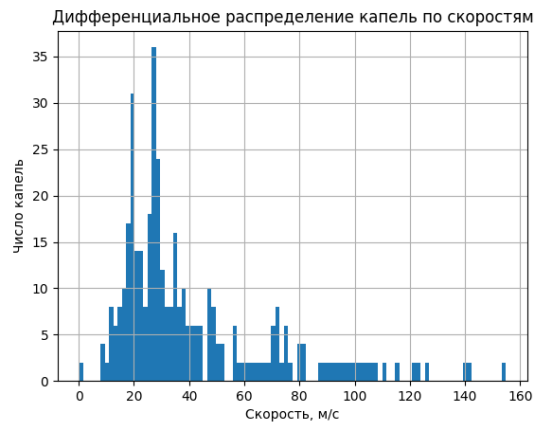
Рисунок 5.2.77 – Id 90807, дифференциальное распределение каплей по скоростям при d = 1 мм, \Pi_1 = 4,34 , P_\phi = 8,1 атм, L = 150 мм, w = 34 м/с, d_{32} = 44 мкм
