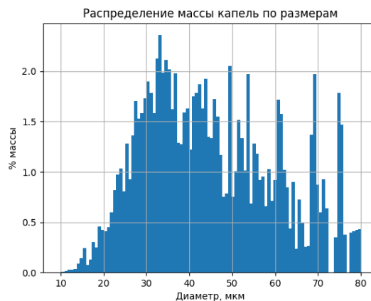
Рисунок 5.2.15 – Id 140803, распределение капель по размерам при d = 2,9 мм, \Pi_1 = 1 , P_\phi = 5,5 атм, L = 400 мм, w = 31 м/с, d_{32} = 40 мкм
