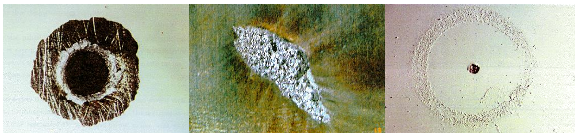
Рисунок 2.2 - Последствия столкновений поверхности спутника LDEF
