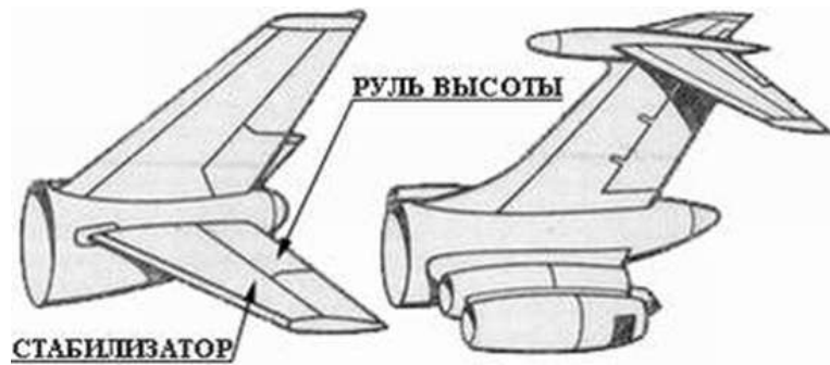
Рисунок 25 - Хвостовое оперение: палубной (слева) и Т-образной (справа) схемы.
