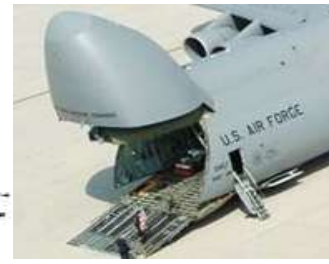
Рисунок 18 - Отклоняемые части фюзеляжа транспортного самолета
