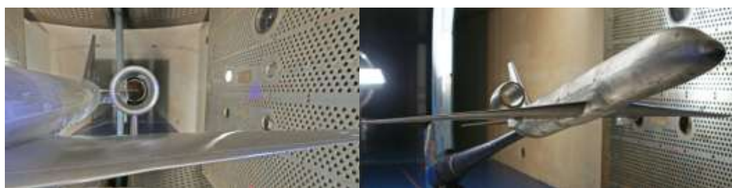
Рисунок 24 - Модель ближнемагистрального самолета с ламинарным крылом
