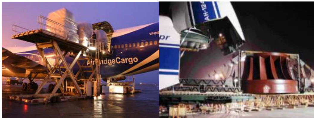
Рисунок 17 - Погрузка генерального груза в Boeing B-747 (слева) и уникального груза в Ан-124-100 (справа)
