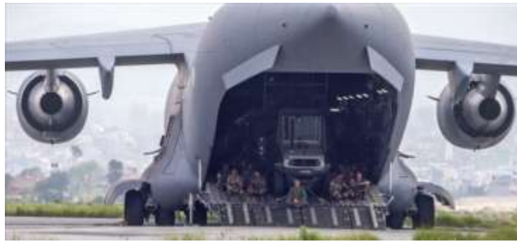
Рисунок 18 - Люк в хвостовой части ВТС С-17. Видны ребра, уменьшающие вихревое сопротивление фюзеляжа и нагрузки на хвостовую часть.
