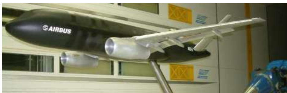
Рисунок 26 - Модель самолета с V-образным оперением в аэродинамической трубе
