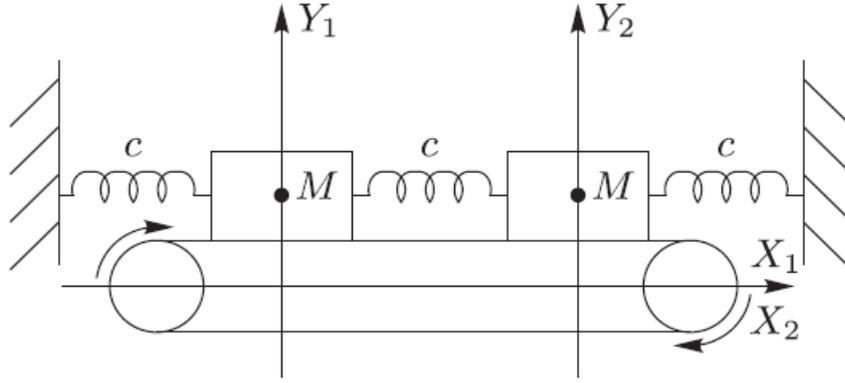
Рисунок 5 – Система из двух ящиков на конвейерной ленте.
