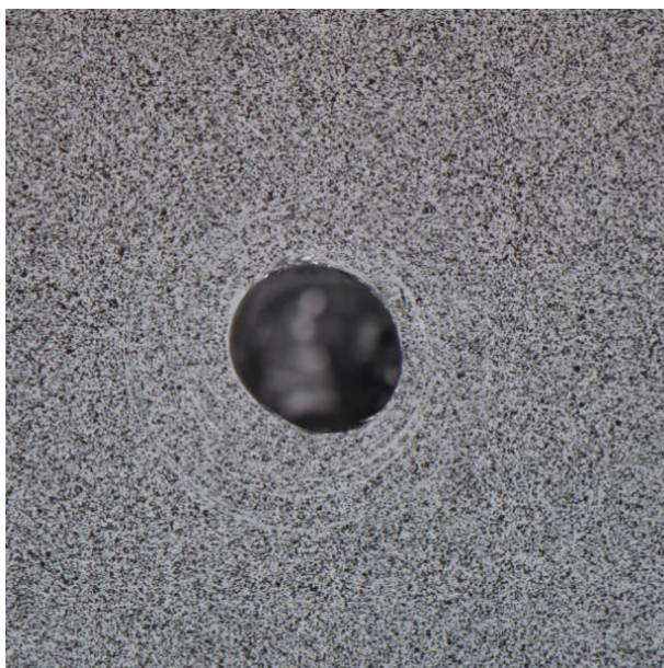
Рис. 3.34. Образование дефектов рисунка-паттерна вокруг отверстия вследствие образования стружки при сверлении.
