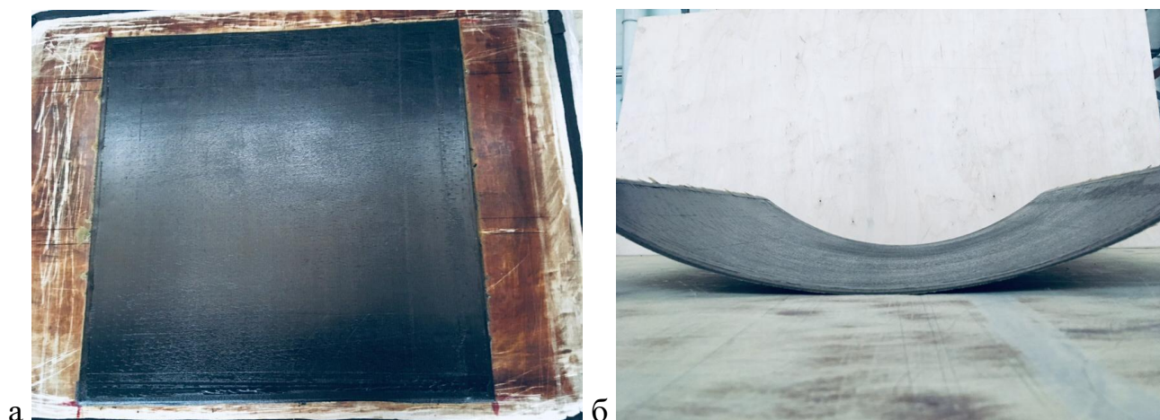
Рис. 2.5. Изготовленная пластина из ВКУ-30 (а- заготовка на оснастке, б- изготовленная пластина)
