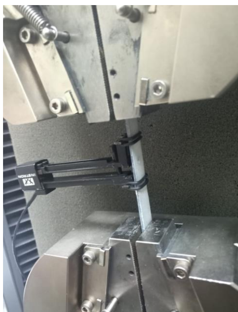
Рис. 3.17. Тестовые образцы (а), для которых испытания на растяжение проводились с использованием контактной тензометрии (б) и с фотосъемкой поверхности с последующим DIC-анализом (в).
