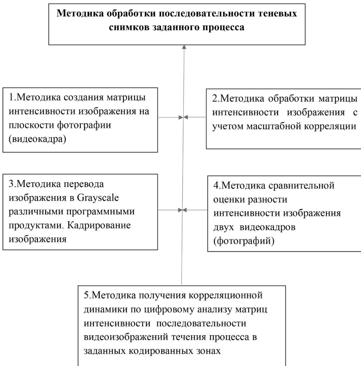
Рис. 3.1. Схема обработки теневых снимков течения процесса по параметру – интенсивность изображения
