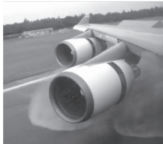
Рис. 2. Истечение газовых струй на самолете Боинг-747
