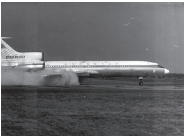
Рис. 1. Внешняя аэродинамика силовой установки самолета Ту-154Б. Визуализация реверсивных струй, истекающих из нижних окон РУ
