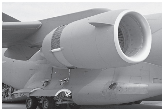
Рис. 5. Перекрытие нижней части реверсивных решеток
