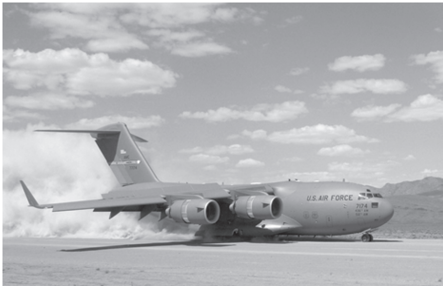
Рис. 4. Посадка самолета С-17 на грунт с применением реверса тяги
